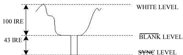
图7. RGB视频输出波形
