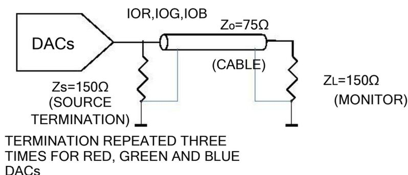
图9. 针对 RS-170A的模拟输入终端
