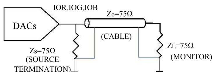
图8. 针对 RS-343A 的模拟输入终端
